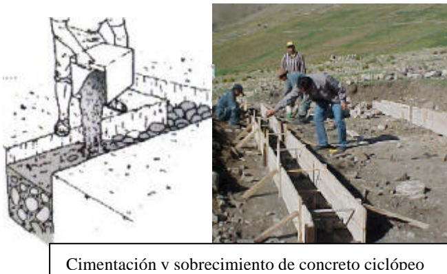
Figura 8. Mejoras estructurales en viviendas nuevas de adobe.
