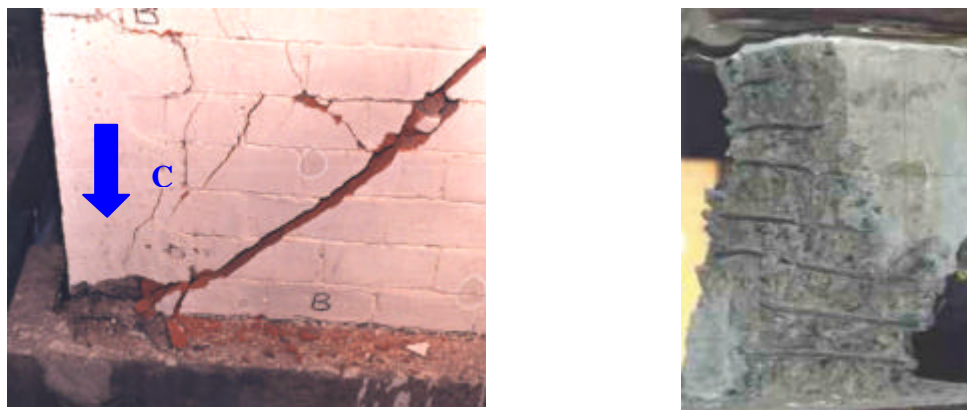
Figura 17. Falla por aplastamiento de una columna (izquierda) y desprendimiento del recubrimiento, manteniendo el núcleo confinado sin daños (derecha)
