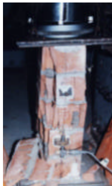
Figura 2. Falla frágil a compresión axial en un prisma hecho con ladrillos con 40% de huecos
