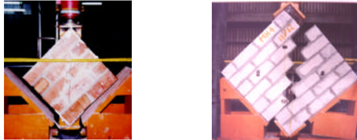
Figura 11. Muretes sujetos a compresión diagonal: falla por tracción diagonal (izquierda) y falla escalonada por falta de adherencia ladrillo-mortero (derecha)
