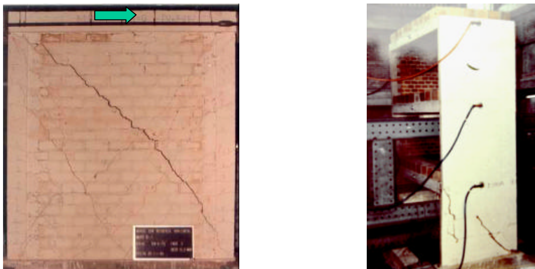
Figura 4. Ensayos de carga lateral cíclica (izquierda) y de simulación sísmica de un módulo de tres pisos (derecha) por San Bartolomé, Quiun y Torrealva (1992)
