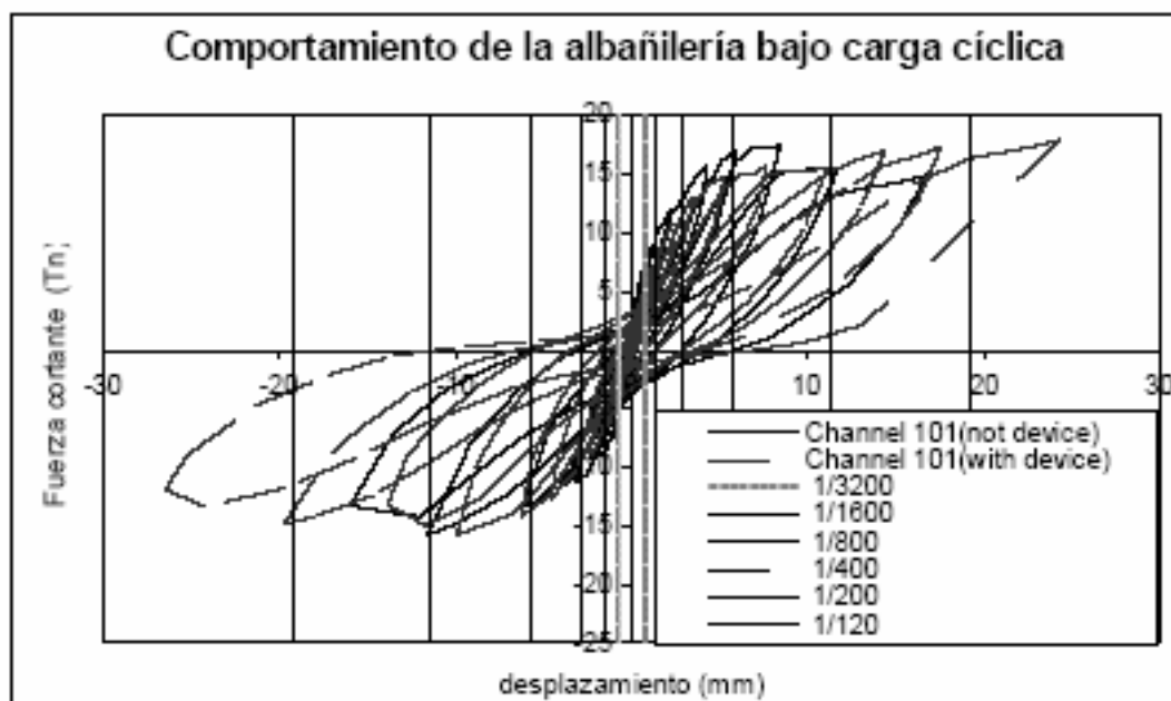
Figura N° 4. - Comportamiento de los especímenes bajo cargas cíclicas
