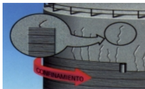
Gráfico 02: Prácticamente cualquier estructura puede reforzarse con fibras de carbono, como tanques o silos.
